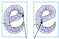
Position des points de fixation avec connexion optimale (gauche) et avec connexion automatique (droit). Les points de bâti et de fixation peuvent être placés dans une place bien définie.
