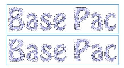
Texte avec connexion optimale (haut) et connexion automatique (bas).
