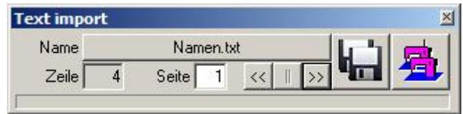
Schon seit langem ist es in Verbindung mit der Schablonenfunktion möglich, hunderte Namen oder Texte, auch mit Stickmuster in Kombination, in einem Arbeitsschritt an den Ringbuffer der ZSK-Stickmaschine zu übergeben. Die Stickmaschine arbeitet dann jedes einzelne Muster mit Monogramm nacheinander ab, das BasePac sorgt vollautomatisch für die Datenberechnung und Datenbereitstellung.
