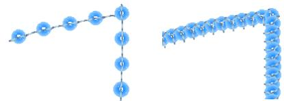
Paillettenflächen lassen sich sehr schnell dadurch füllen, dass man eine Grundlinie (auch kurvig!) zeichnet und diese als Parallele über die Fläche verteilt. Durch Übernahme dieser Linien in das Paillettenprogramm ist eine Fläche schnell und vor allem individuell mit Pailletten zu füllen.
